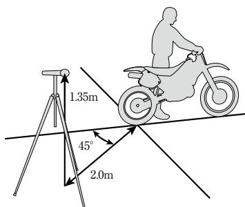
1-1-3-3 サイレンサーが1本を超えるエンジンの音量計測は、いずれか一方のエキゾーストパイプの先端で計測される（必要に応じて両方の先端で測定する）。
